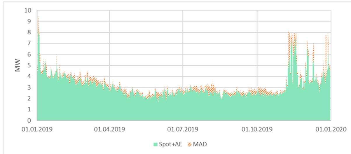
Stundenaufgelöste Darstellung der generierten Netto Ausgleichsenergien zeigen Schwachstellen und mögliche Optimierungspotenziale
